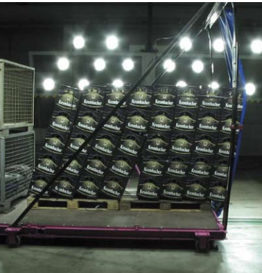
Abb. 2: DEKRA Fahrdynamische Tests (Simulation seitlicher Schiebeplanaufbau)
