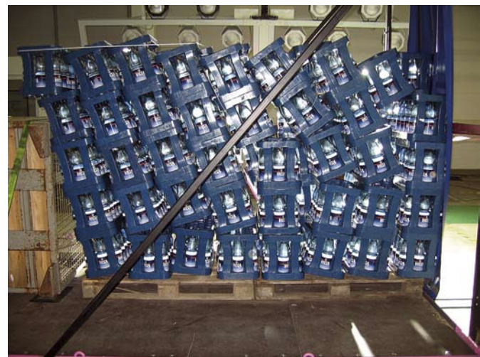
Abb. 3: Die Kastenkontur beeinflusst das Säulenverhalten
